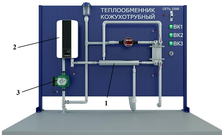
Рис. 1. Лабораторная установка для изучения теплообмена в кожухотрубном теплообменнике: 1 – кожухотрубный теплообменник; 2 – водонагреватель для приготовления горячей (греющей) воды; 3 – циркуляционный насос греющей воды
