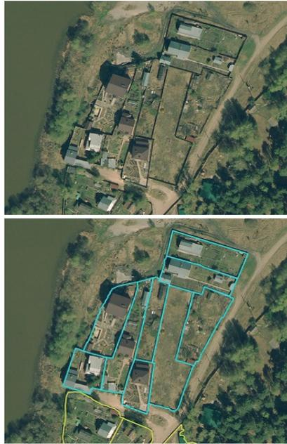
Рис. 2. Определение границ земельных участков с помощью алгоритмов нейронной сети, созданной компанией «ИнноГеоТех» и университетом Иннополис
